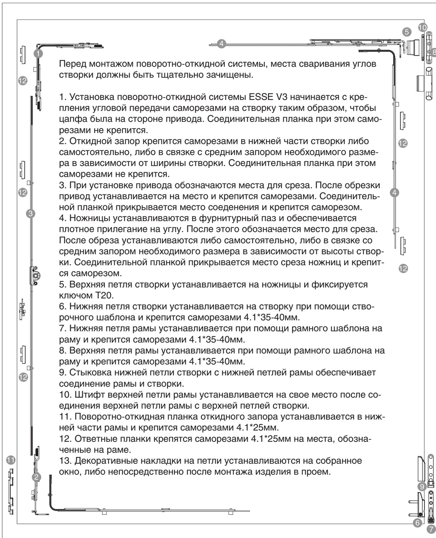
Перед монтажом поворотной-откидной системы, места сваривания углов створки должны быть тщательно зачищены.
