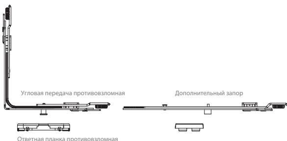
Угловая передача противовзломная
